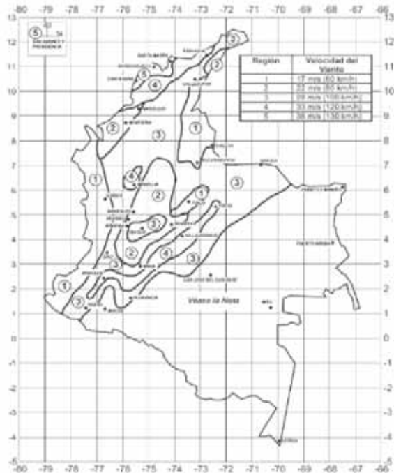
Figura 10. Cargas de Viento. Fuente: NSR-10
