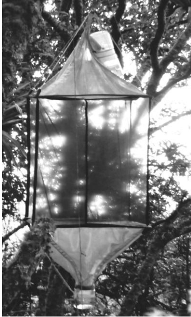
Figura 1. Trampa aérea de interceptación de vuelo
