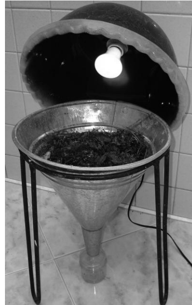
Figura 2. Embudo Berlese para muestras de suelos suspendidos de dosel.
